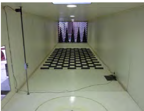
Figura 6: Vista de los elementos de rugosidad y de los spikes.
